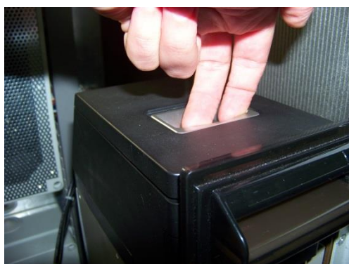
Rysunek 17 – otwieranie walidatora banknotów
